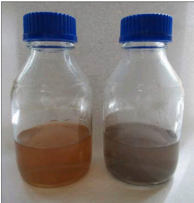
4. ábra: A CEM I 32,5 N-LH (balra) és a CEM II/A-M (V-LL) 42,5 N (jobbra) salétromsavas oldás után
