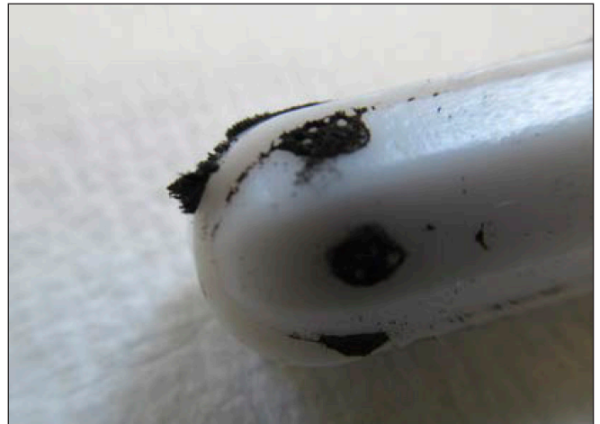
6. ábra: A mágneses keverőbotra tapadt vaspor
